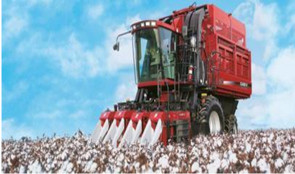
Şəkil 1. COTTEN EXPRESS 420 pambıqyığan kombaynın ümumi görünüşü.
